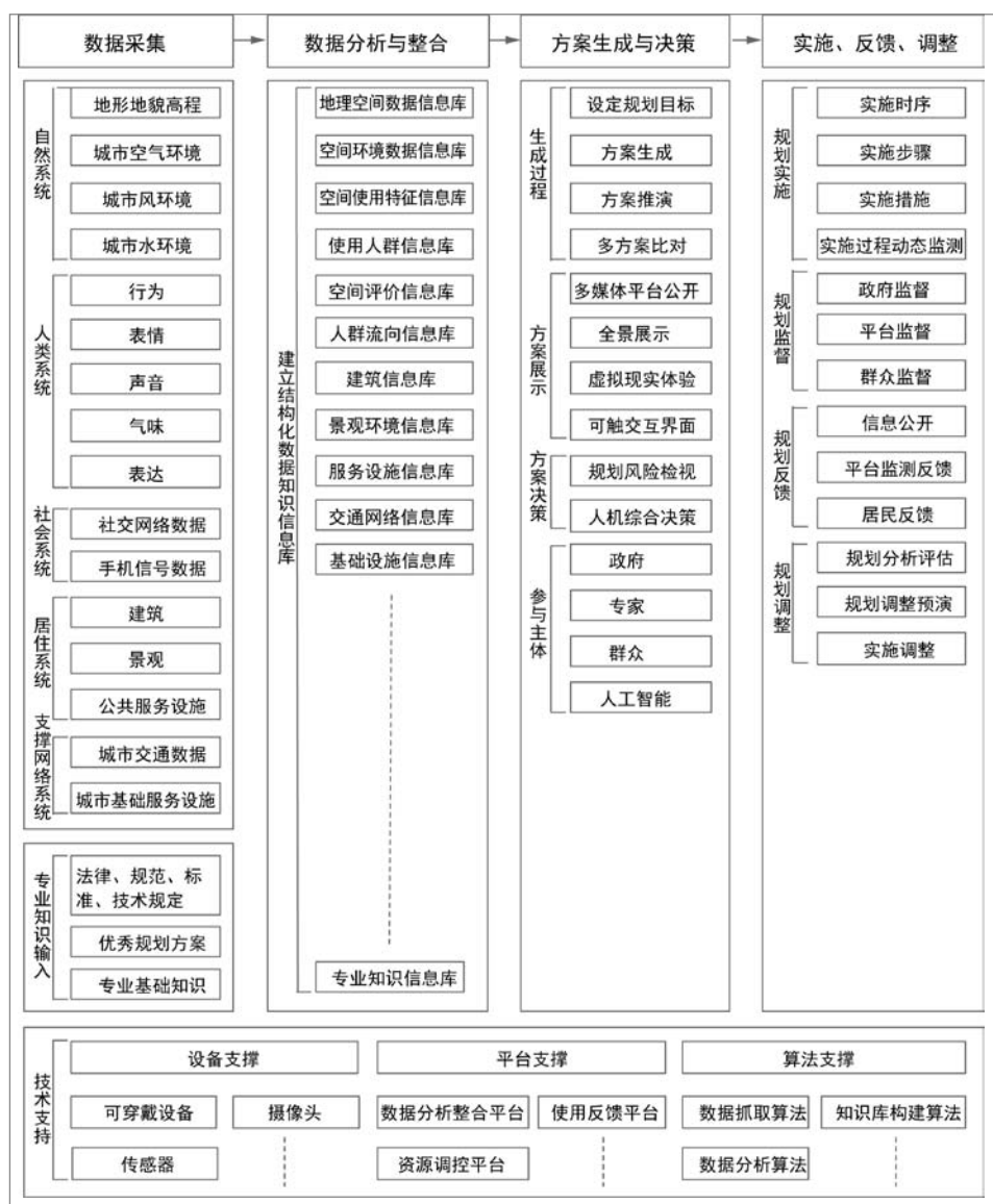
图 1 人工智能 2.0 时代的城市动态规划流程图
