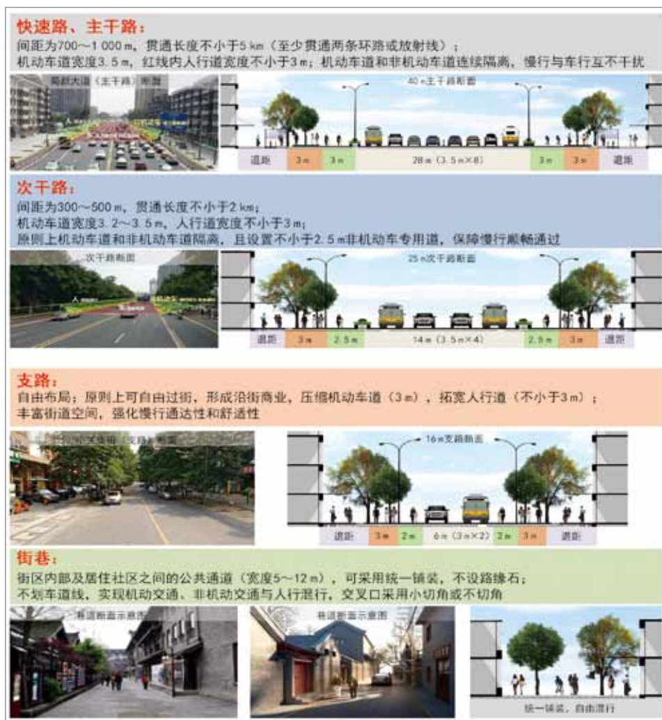
图1 “快速路—主干路—次干路—支路—街巷”道路断面示意图
