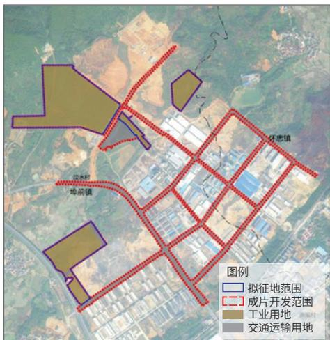
图4 某县公示方案“圈路”现象示意图
